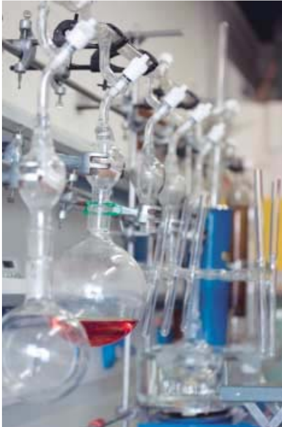
Γραμμή υψηλού κενού στα εργαστήρια του ΙΘΦΧ για τη σύνθεση πολυσυσταδικών μακρομορίων με τη μέθοδο του ανιοντικού πολυμερισμού. Τέτοιου είδους μακρομόρια επιτρέπουν την ανάπτυξη ανόργανων-οργανικών υβριδικών υλικών, διασπορών νανοσωματιδίων, φορέων ελεγχόμενης αποδέσμευσης φαρμάκων και άλλων εφαρμογών.
