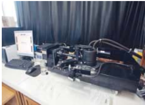
Φωτόμετρο σκέδασης φωτός με γωνιόμετρο μεταβαλλόμενης γωνίας στα εργαστήρια του ΙΘΦΧ. Αποκτήθηκε το 2006 και αποτελεί το πρώτο συμπαγές σύστημα της κατηγορίας του στην Ελλάδα. Καθιστά δυνατή την πραγματοποίηση μετρήσεων στατικής και δυναμικής σκέδασης φωτός για την εύρεση του μοριακού βάρους, του μεγέθους και της κατανομής μεγεθών συνθετικών πολυμερών, βιολογικών μακρομορίων και ανόργανων / οργανικών νανοσωματιδίων σε διασπορά.
