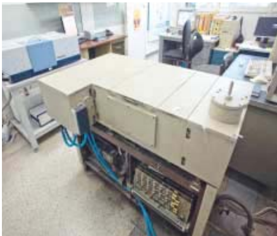
Δύο φωτόμετρα κενού που καλύπτουν την περιοχή του μέσου και άπω υπερούθρου στο ΙΘΦΧ. Σε πρώτο πλάνο, το φωτόμετρο 11.3ν της Bruker, που αγοράστηκε το 1985 και, σε συνδυασμό με τα φωτόμετρα Raman, χρησιμοποιείται στη μελέτη υλικών. Σε δεύτερο πλάνο αριστερά, το νέο φωτόμετρο (Bruker, Vertex 80ν), που αποκτήθηκε το 2007.
